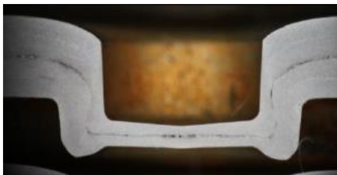
41. ábra: 1 mm lemezvastagságú valóságos lemezpár keresztmetszeti képe (0,51 mm fenékvastagság) [24]
