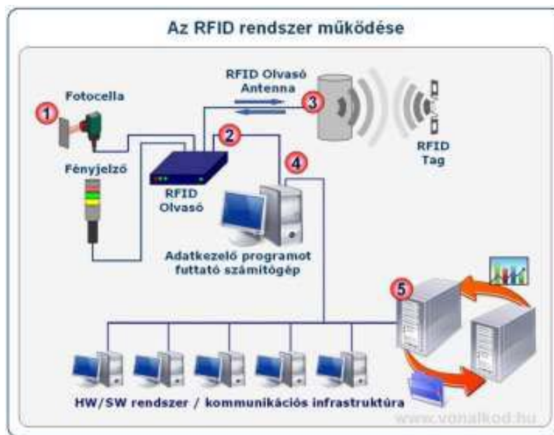
25. ábra: Az RFID rendszer működése
