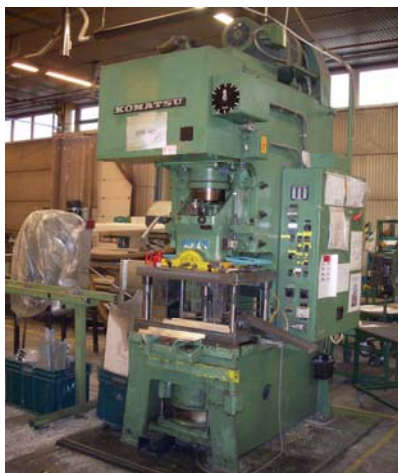
4. ábra. Kivágó-lyukasztó gép (bal oldalon) és szerszám (jobb oldalon)
